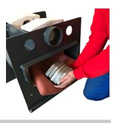
12. Entnehmen Sie die alten Rostelemente, aber achten Sie auf die korrekte Reihenfolge.
