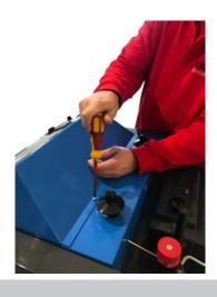
2. Entfernen Sie die 2 oberen Schrauben der Gerätehaube
