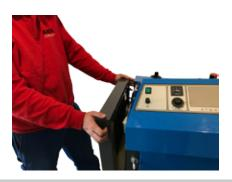
5. Heben Sie die Seitenverkleidung etwas an, um sie dadurch auszuhängen und zur Seite zu kippen.
