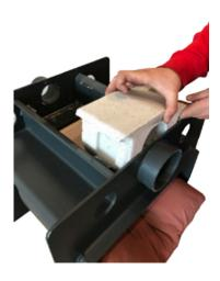
13. Demontieren Sie abschließend durch Anheben anch oben den vorderen und hinteren Rostwürfel. Wenn dieser fest sitzt, hebeln Sie ihn mit einem Meisel aus seinem Sitz.
