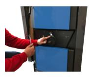
8. Lösen Sie das Arretierungsblech und drehen es zur Seite - wie im Bild dargestellt.
