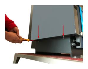
3. Entfernen Sie die 2 Schrauben am unteren Rand der Seitverkleidung. Sie müssen nur 1 Seitenblech lösen.
