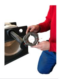
16. Wenn Sie nun die einzelnen Rostelemente auffädeln, beachten Sie deren Ausrichtung (Luftkanal nach unten gerichtet)
