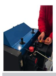
1. Lösen Sie die Erdungsschraube an der Rückseite des Gerätebretts.
