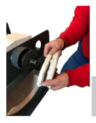
18. Achten Sie beim Einsetzten der 2 Dichtschnüre darauf, dass als erstes die schmale und danach die stärkere Dischtschnur eingesetzt wird. Schieben Sie mit Drehbewegungen das Rostrohr bis Anschlag ein.
